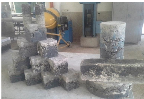
شکل ۵- نمونه ۸ مولار با ۳۰٪ دوده سیلیس بدون فوق‌روان‌کننده
