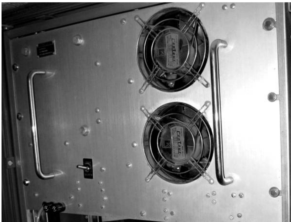
Илл. 16: Нижний источник питания аналитического комплекса.
