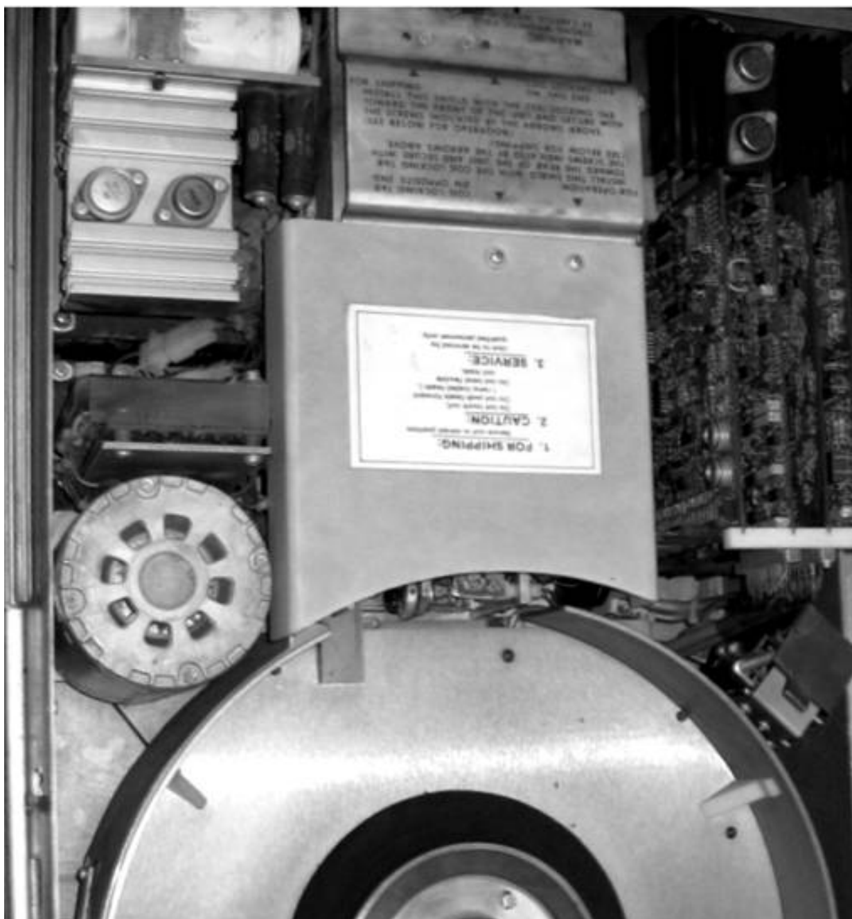
Илл. 15: Жесткий диск. Вид сверху со снятыми металлическими кожухами.
