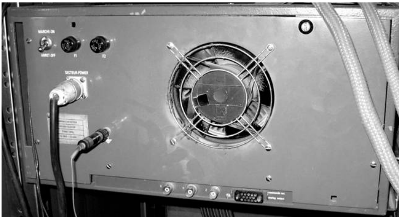
Илл. 5: Дисплейный модуль, вид сзади: видны разъемы X, Y, Z.
