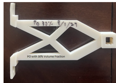
Fig. 14: 30% VF PO Beam
