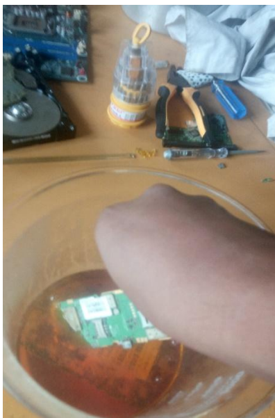
Figure 25: dissolving PCB into aqua regia solution
