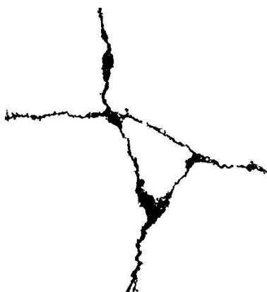
448 449 Fig. 23: Complex crack detection by SOM
