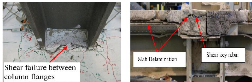
شکل ۲. ایجاد ترک در دال مجاور ستون فولادی در اثر تغییر شکل جانبی
