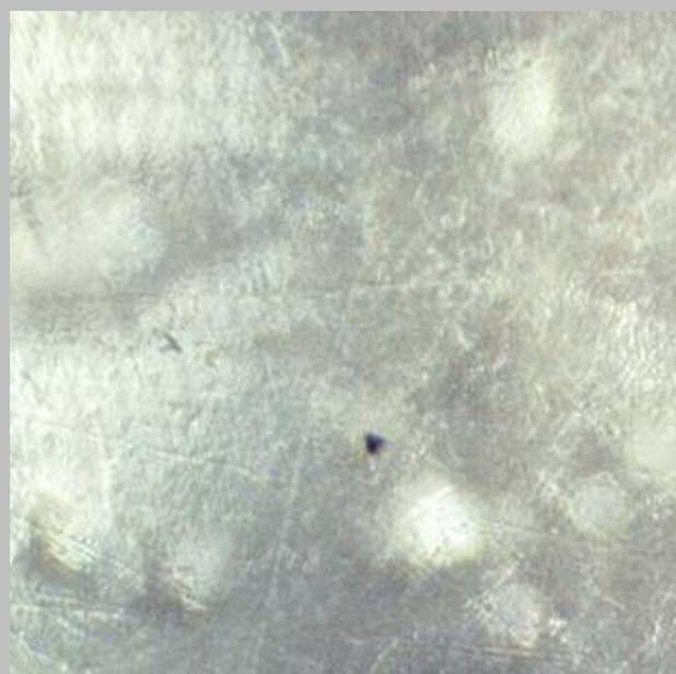
Наблюдение формирования групп и цепочек воздушных пузырей в полимерном слое чипа непосредственно под гладкой поверхностью, часть которой абразивно повреждена.
