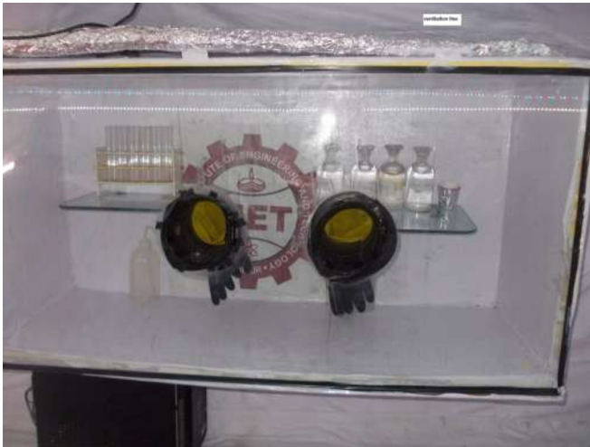
Fig. 18. Inert chamber demonstrator – module 1729
