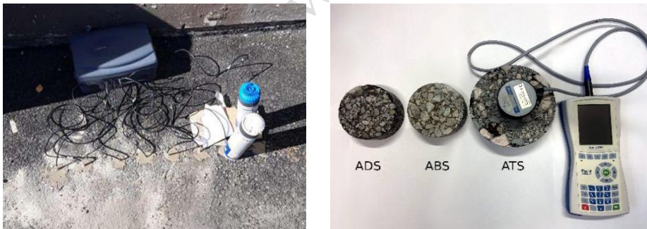
Bild 3: Temperatursensoren (links) und Wärmeübertragungsanalysator Isomet 2114
