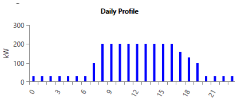
Şekil-1: İHA Yer Kontrol İstasyonu'nun günlük ortalama elektriksel yük profili.
