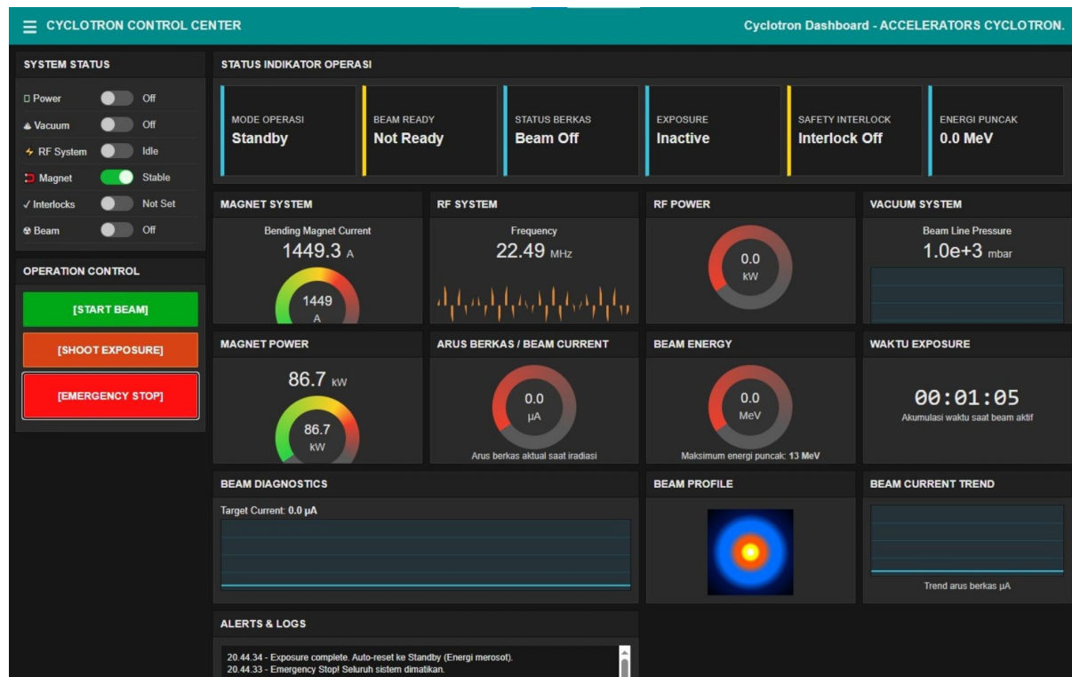
Gambar 1. Tampilan dashboard HMI Node-RED pada alat peraga ruang kontrol siklotron
