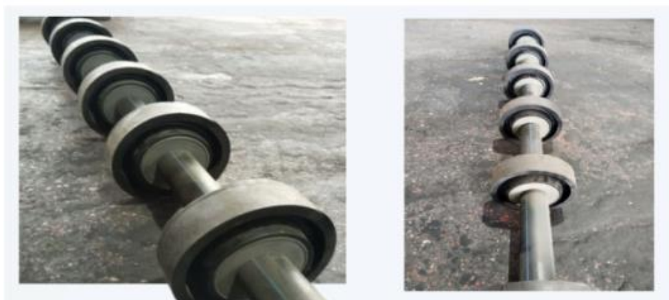
Рисунок 2 — Опытный образец ролика ремонтпригодной конструкции
