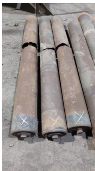
Рисунок 1 — Сквозное протирание корпуса
